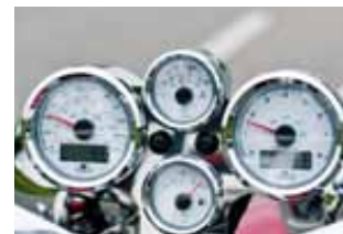
Die neue Generation: VDO-Instrumente in Marinequalität. Laut Hersteller beschlagfrei und mit genauer Tankanzeige. Integrierter Bordcomputer, Zeituhr, Voltmeter – alles ab sofort serienmäßig.
