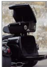
Hoher Beifahrerkomfort. Aufbaukoffer ist längsverstellbar für optimale Beifahrersitzposition. Großer Kofferraum.
